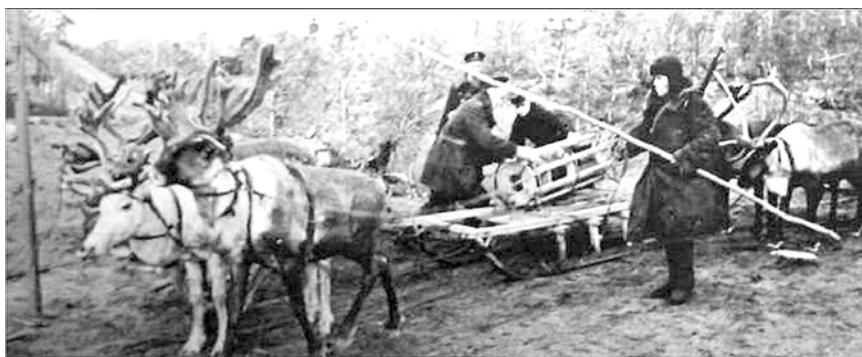
Погрузка авиационного мотора. В данном случае он невелик, так что грузовая упряжка обычного состава потянет его даже по чернотропу. Самые тяжелые из моторов перевозили на особо укрепленных грузовых нартах, а поврежденные самолеты — на специальном нартовом помосте, в который впрягали не менее 20 сильных оленей
